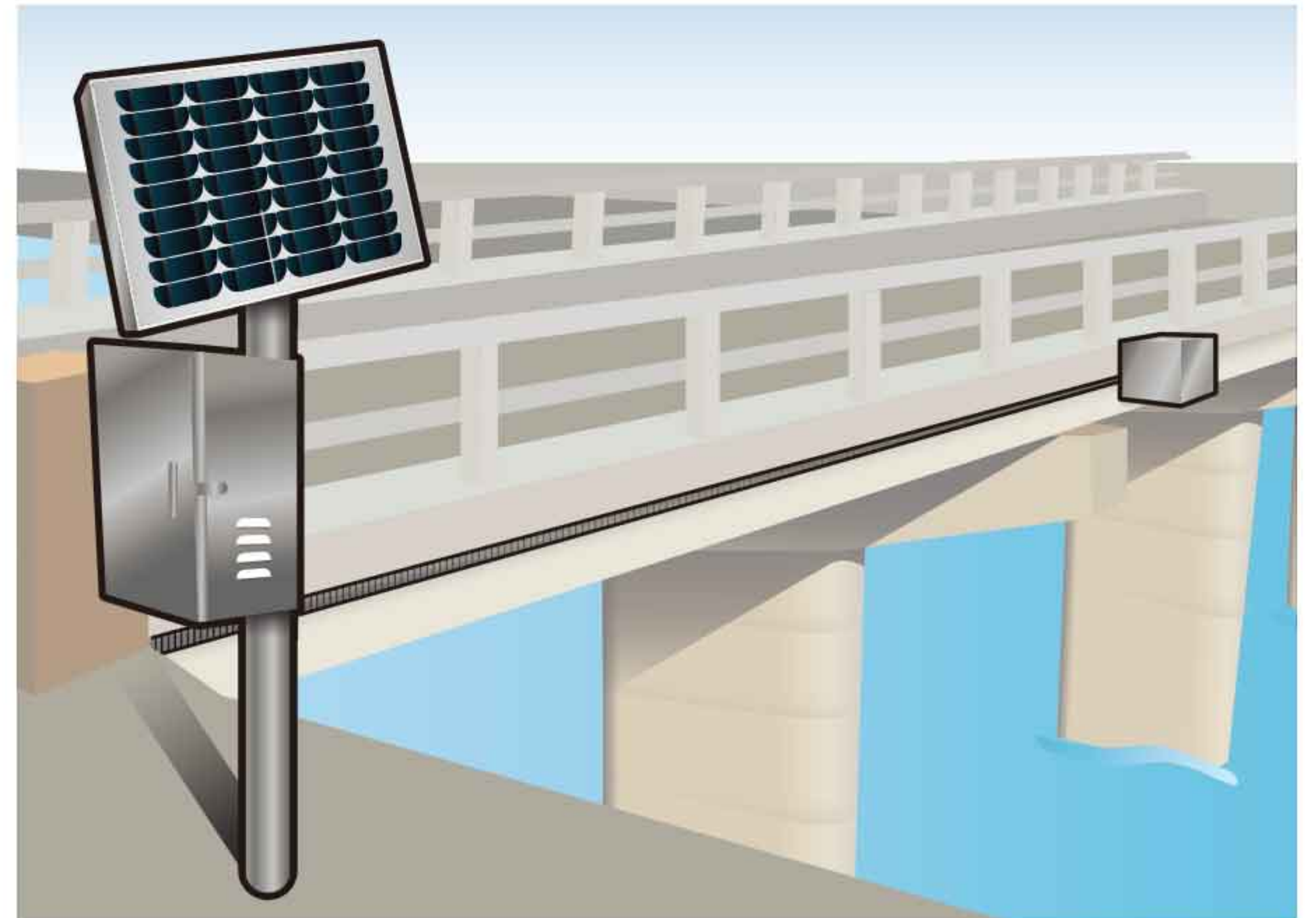
본 이미지는 수위전송시스템(초음파식 수위계)이 현장에 설치된 모습을 표현한 예상도입니다. 따라서 현장 상황에 따라 달라질 수 있습니다.
